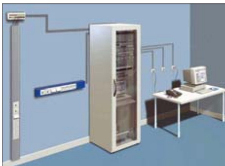
Obr. 1 Princip strukturované kabeláže LexCom Office
