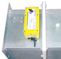
Výstup z pohonu je proveden jako dvojitý čtyřhran 12 x 12 mm. Hřídel klapky může být ponořena do výstupní náboje až 20mm. Při tomto způsobu montáže musí být pohon s klapkou nebo adaptační deskou prošroubován/spojen napevno.
