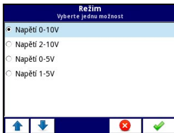
Obr. 65: Dostupné rozsahy proudových a napěťových vstupů v parametru "Režim"
