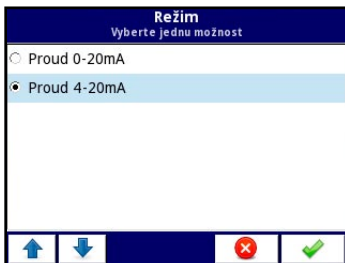
Obr. 65: Dostupné rozsahy proudových a napěťových vstupů v parametru "Režim"
