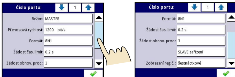
Obr. 95: Parametry menu "Modbus" v režimu MASTER
