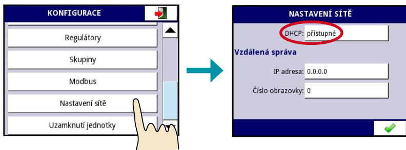
Obr. 97: Parametry menu "Nastavení sítě" s aktivovaným protokolem DHCP
