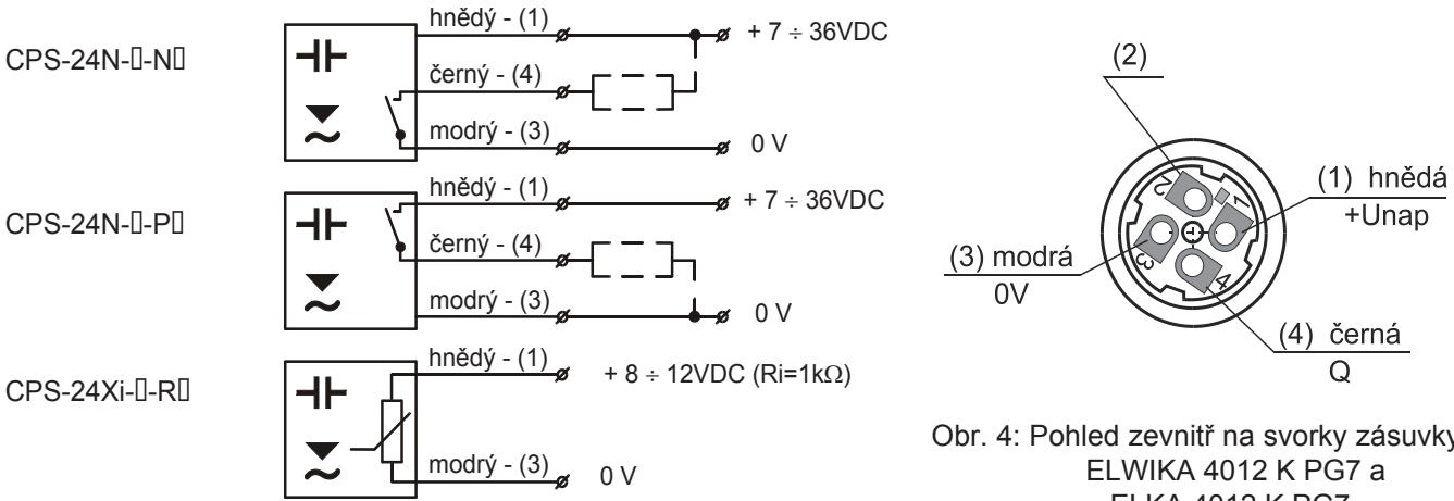
Obr. 3: Připojení snímačů
