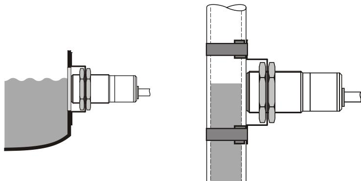
Obr. 2c: Aplikace snímačů CPS na stavoznaky a průhledítka
