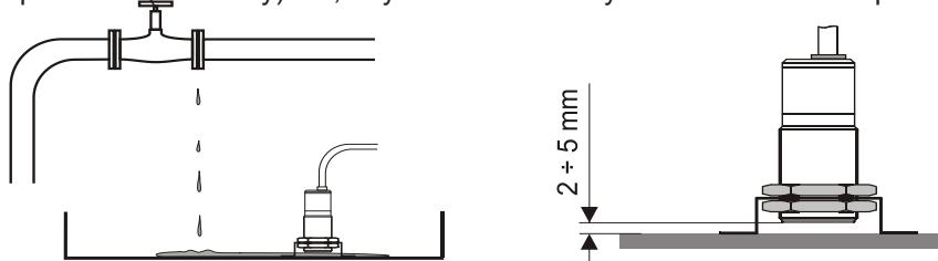
Obr. 2e: Použití CPS ke snímání úkapků v záhytné vaně
