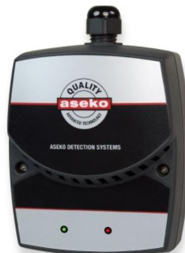
**Snímače koncentrace řady GT** slouží k detekci nebezpečné koncentrace hořlavých plynů a k detekci toxických plynů a par na úrovni hygienických limitů. Měřicím prvkem je elektrochemický (**GTE**), katalytický (**GTC**), polovodičový (**GTS**) nebo infračervený (**GTO**) senzor.
